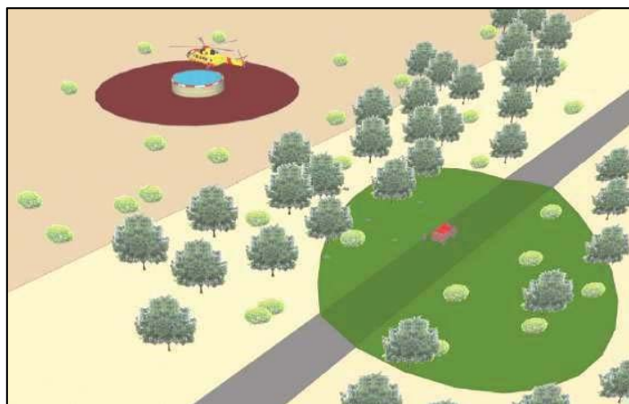
Imatge 10: Esquema de zona de protecció al voltant del punt de càrrega i al voltant del mateix punt d'aigua
